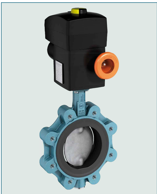
Válvula de mariposa tipo lug con orificios roscados. Esta versión permite embriar tuberías por un lado.
